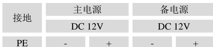
图 3-4 电源及接地端子
